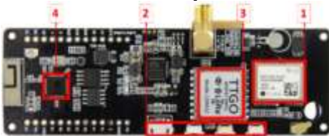
Gambar 5. LoRa Node sebagai alat pelacakan di truk.
