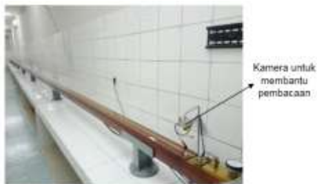
Gambar 2. Standar Panjang 20 m dan Ketelitian 0,01 mm
