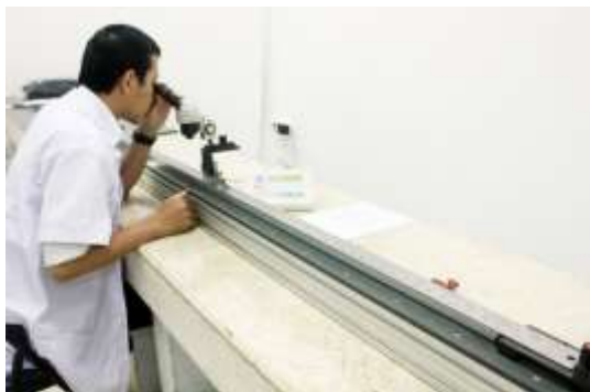
Gambar 5. Alat Standar Kalibrasi Menggunakan Metode JIS B 7516
