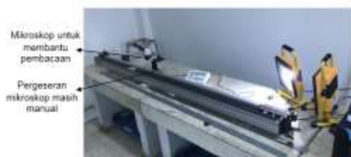
Gambar 3. Standar Panjang Sistem Kelistrikan 2 m dan Ketelitian 0,005 mm
