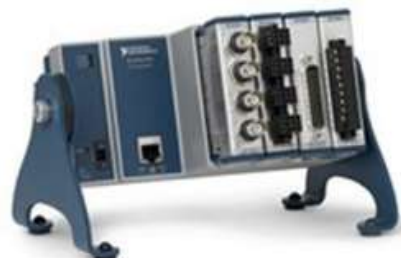
Gambar 6. Perangkat NI CompaqDAQ-9184
