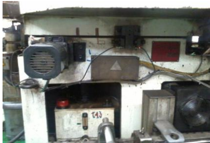
Gambar 11. Assembling stopper dan dudukan motor
