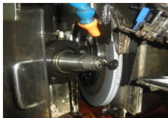
Gambar 2. posisi pemakanan parts oleh batu gerinda
