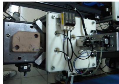
Gambar 4 Posisi Sensor Terhadap Benda Kerja
